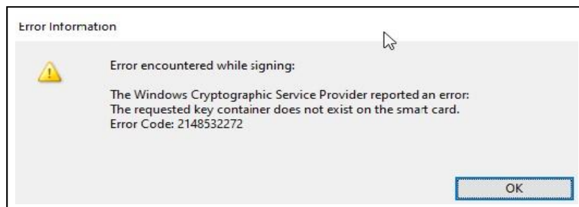
Slika 2.2. Greška koja se javlja prilikom pokušaja potpisivanja PDF dokumenta kada QSCD smart kartica/USB token nisu aktivirani
